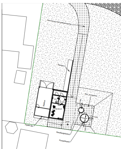
Situationsplan for ny pumpestation med adgangsvej
