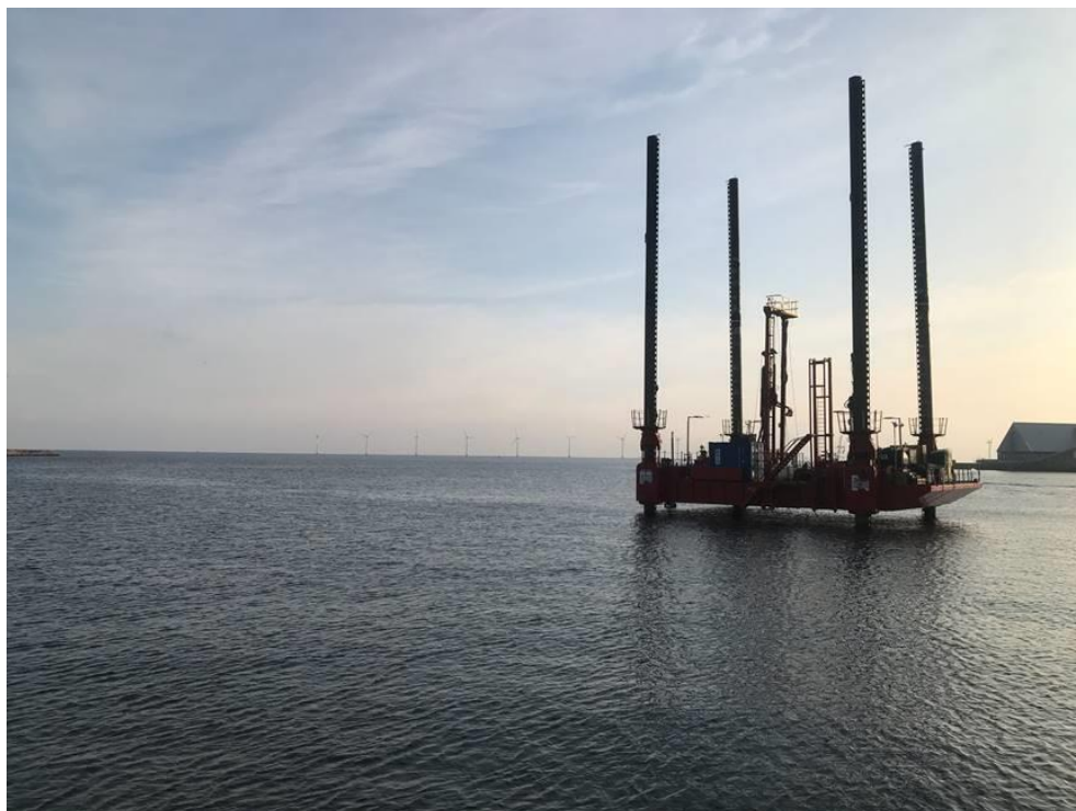
Figur 3: Eksempel på stor jackup flåde. De fire "ben" sænkes og "fødderne" placeres på havbunden, hvorefter riggen løftes op over vandoverfladen. Midt på flåden står en borerig, som udfører selve borearbejdet.
