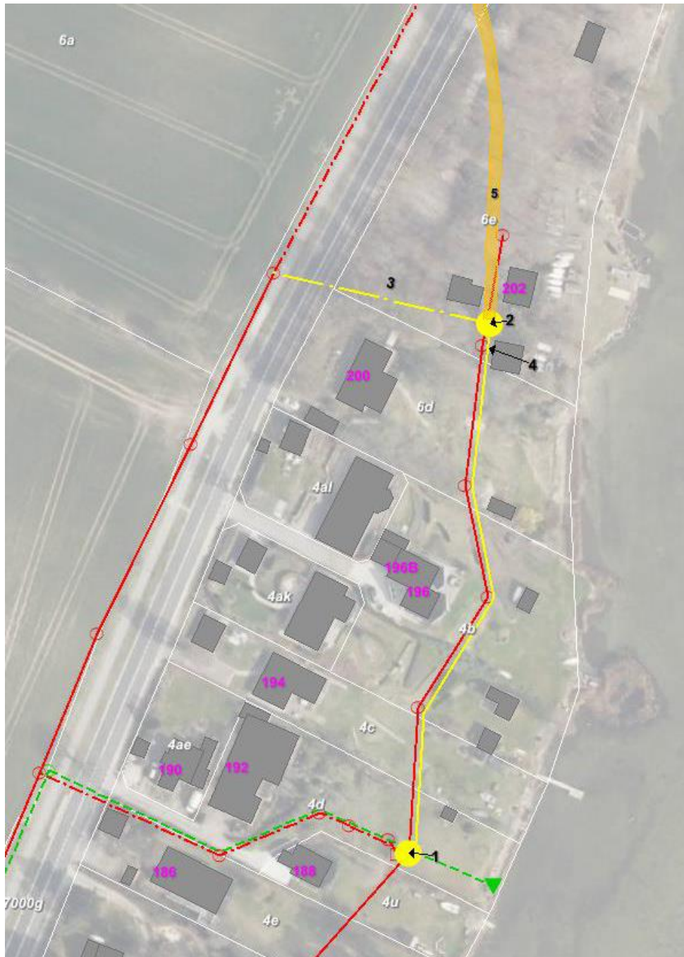
Figur 3: Oversigtskort over det eksisterende og principskitse over det påtænkte anlæg. 1 = Ny gennemløbsbrønd, 2 = Ny gravitationsledning etableret ved styret underboring 3 = Ny pumpestation, 4 = Afskærende trykledning til spildevandsledning i Hornsherredvej, 5 = Elskab, 6 = Udluftning (svanehals), 7 = Eksisterende og fremtidig adgangsvej
