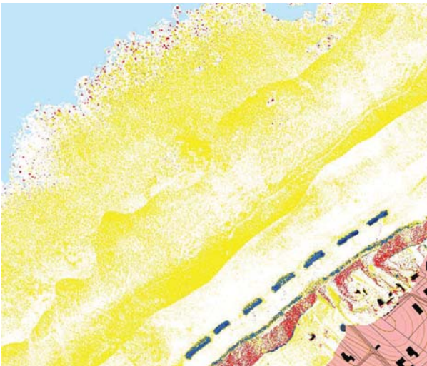
Figur 15 Udsnit af Figur 14; differensplan. Bølgebryderne (blå) fremtræder nu tydeligt. Signaturforklaring som i Figur 14.
