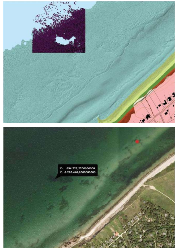
Figur 11 Område med manglende data i laserscanningen (øverst) og et foto af området (Foto: Danmarks Miljøportal).
