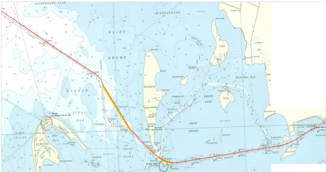
Figur 1: Søkort med indtegnet anlæg i detalje; uddybning til etape 1 er markeret med gul, mens uddybning til etape 2 er markeret med rød.
