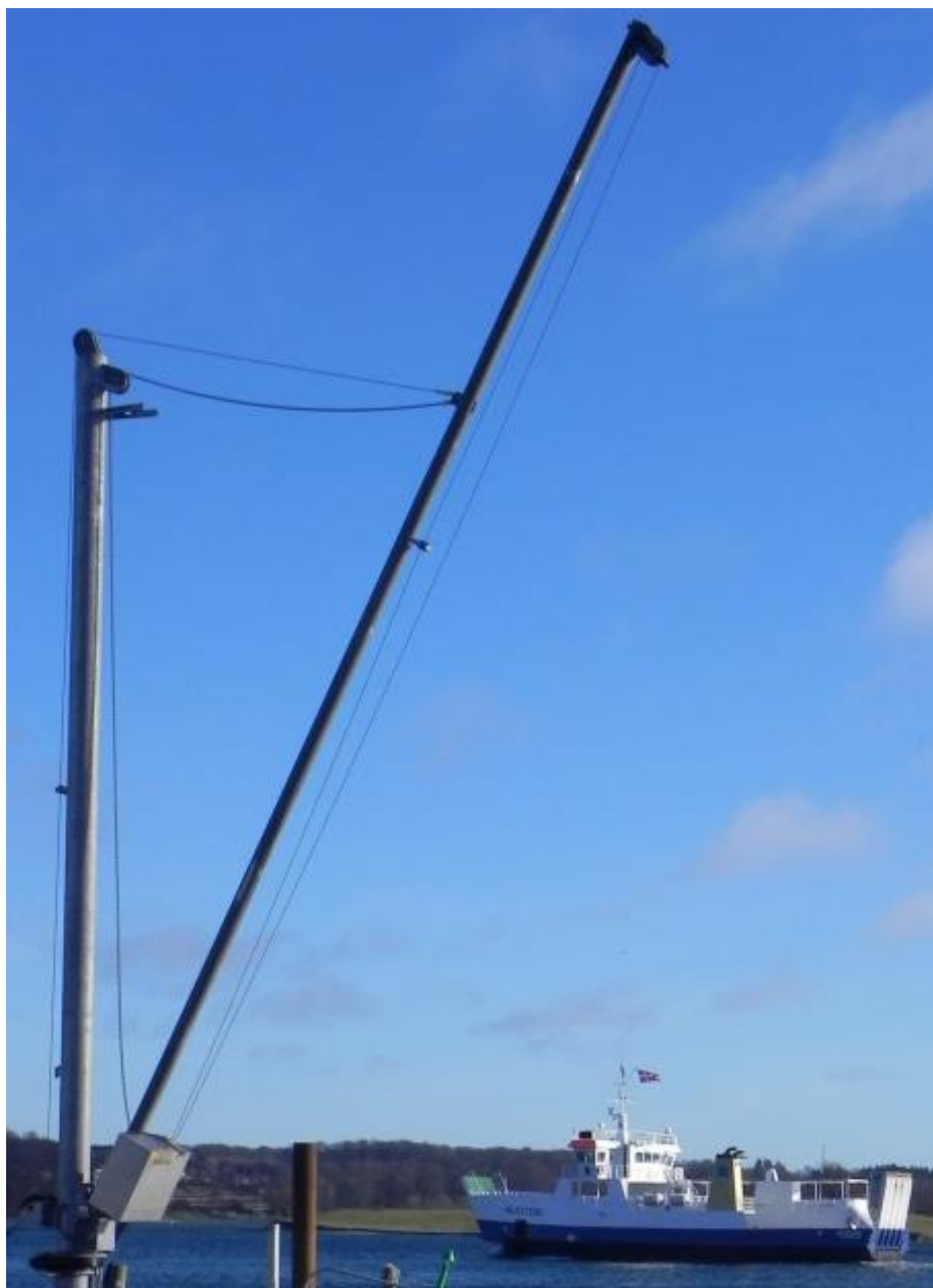
Fig. 25 Mastekran WLL 500 kg med elektriske spil.
