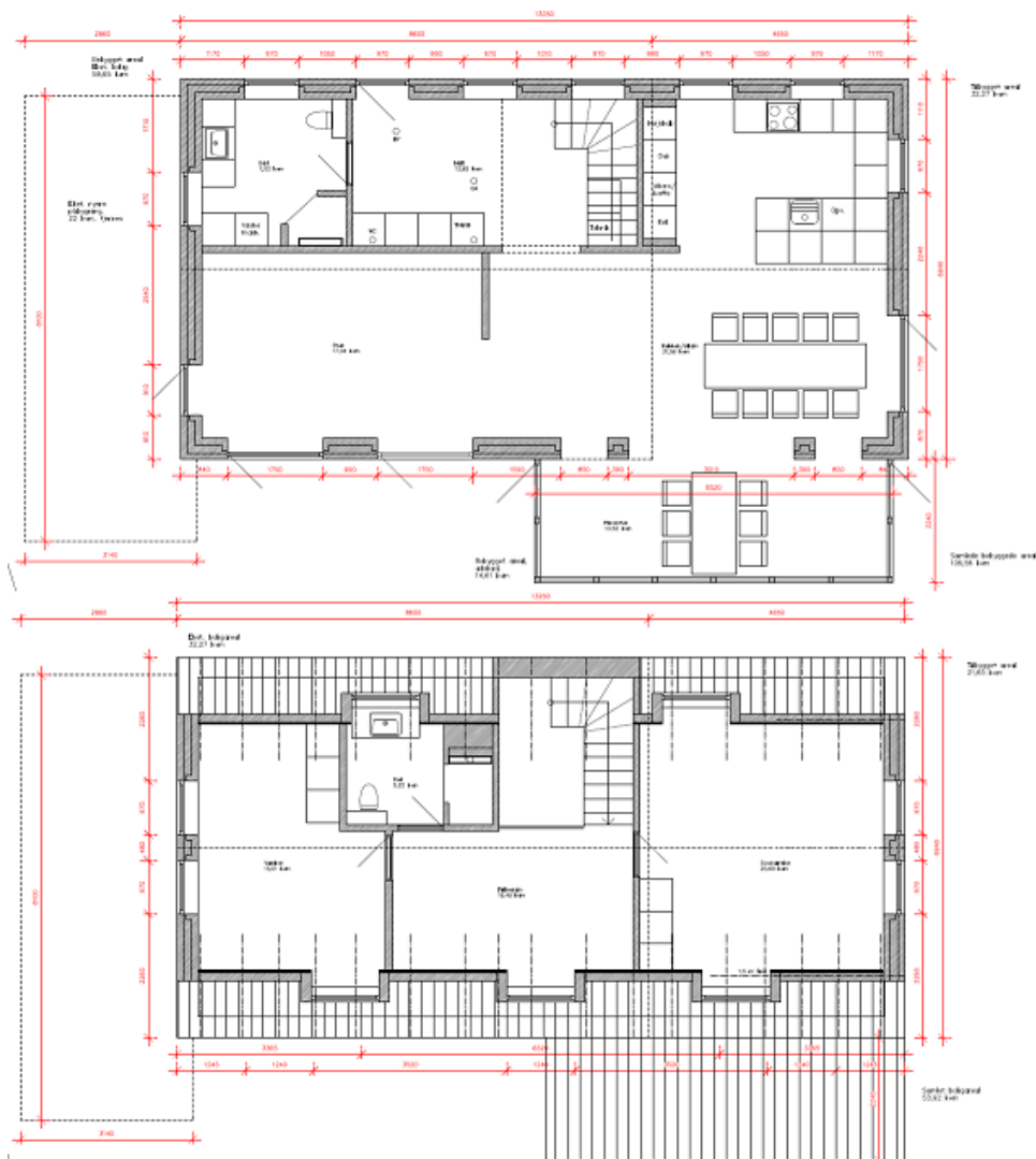
Figur 5: Grundplan for det fremtidige hus, øverste tegning er af stuetagen og nederste er af 1. sal
