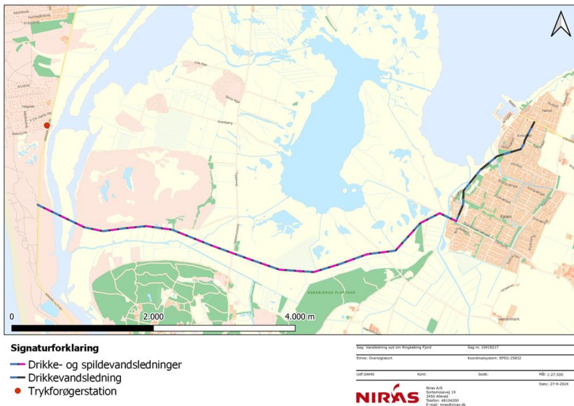
Figur 1: Oversigtskort, der viser tracéet for de nye drikkevands- og spildevandsledninger samt en supplerende trykforøgerstation på eksisterende vandforsyningsledning.
