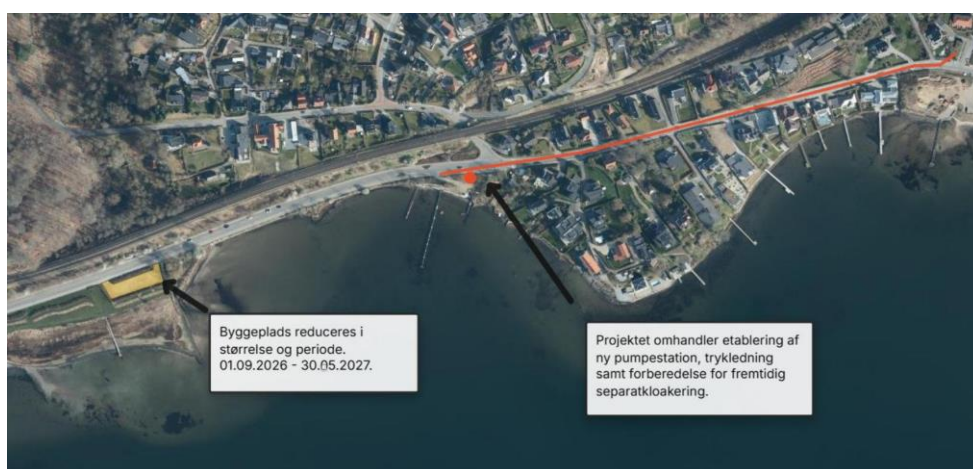
Fig. 2. Oversigtskort over projektområdet, hvorpå placeringen af jorddepotet er indtegnet med gult og placering af pumpestation er indtegnet med rød prik og forløb af trykledning er indtegnet med rød linje. Pumpestation og trykledning placeres og nedgraves uden for det strandbeskyttede areal og kræver derfor ikke dispensation fra naturbeskyttelseslovens § 15.
