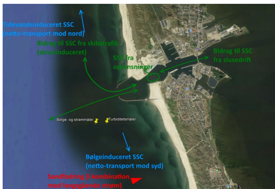
Figur 1-37. Illustration af kilder til påvirkning af baggrunds-SSC. Angivelse af placeringer af bølge- og strømmåler samt turbiditetsmåler i figuren er fra Måleprogram 2020. Baggrundsfoto fra (Google Earth, 2023) [Data: SIO, NOAA U.S. Navy, NGA, GEBCO].
