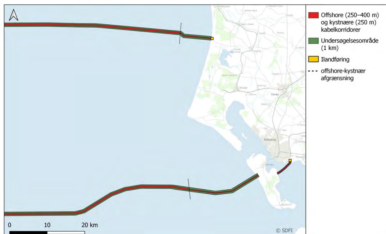
Figur 2.2. Afgrænsning mellem de kystnære og offshore kabelkorridorer for både den nordlige og sydlige rute. De to kystnære delområder 2 og 4 er hhv. 8,6 km og 24,2 km lange. Bemærk, at den endelige placering af det undersøgte kabelkorridor kan afvige fra den vist, dog vil den stadig være inden for undersøgelsesområdet.
