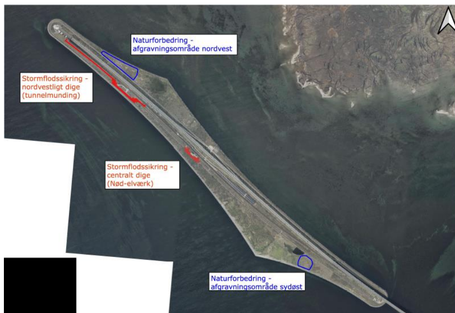
Figur 4-1 Placering af stormflodssikring (tegnet med rødt). Med blå er angivet områder hvorfra materialet til stormflodssikringen afgraves i forbindelse med naturforbedrende tiltag.
