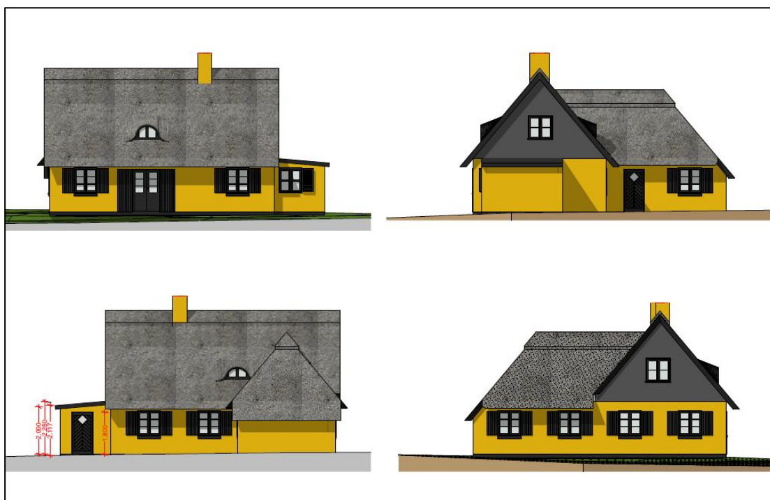
Facader – eksisterende. Nordvendt (mod kysten) ses øverst til venstre. Det fremgår, at den eksisterende sidebygning er 2,0 - 2,2 meter høj
