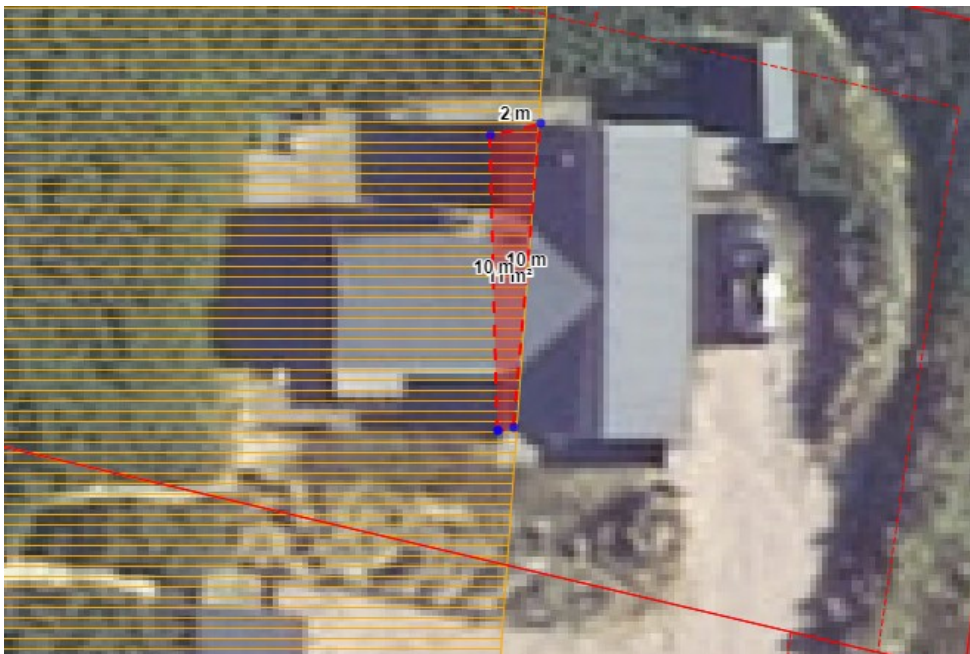
Luftfoto 2020 med opmåling af tagflade i klitfredet område
