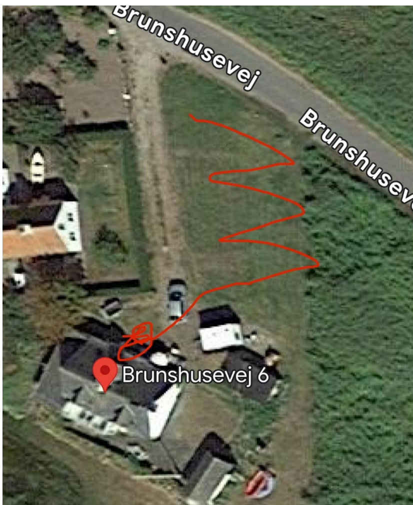
Figur indsendt af ansøger. Jordvarmeslanger nedgraves i det areal, der er markeret med rød. Tæt ved huset er – også med rød – markeret, hvor brønd til samling af slanger placeres. Boligen er markeret med rød nål. Kysten ligger få meter syd for boligen.
