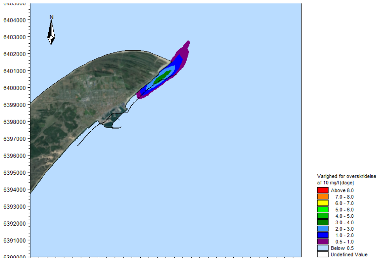
Figur 4-1. Scenarie med kystnær fodring nord for Skagen Havn via rainbowing med to skibe i tilfælde af stille vejr. Figuren viser middel sedimentkoncentrationer under fodringen (øverst) og varighed for overskridelse af 10 mg/l (nederst). Den sorte linje parallel med kystlinjen markerer seks meter dybdekurven (Miljøstyrelsen, 2020).
