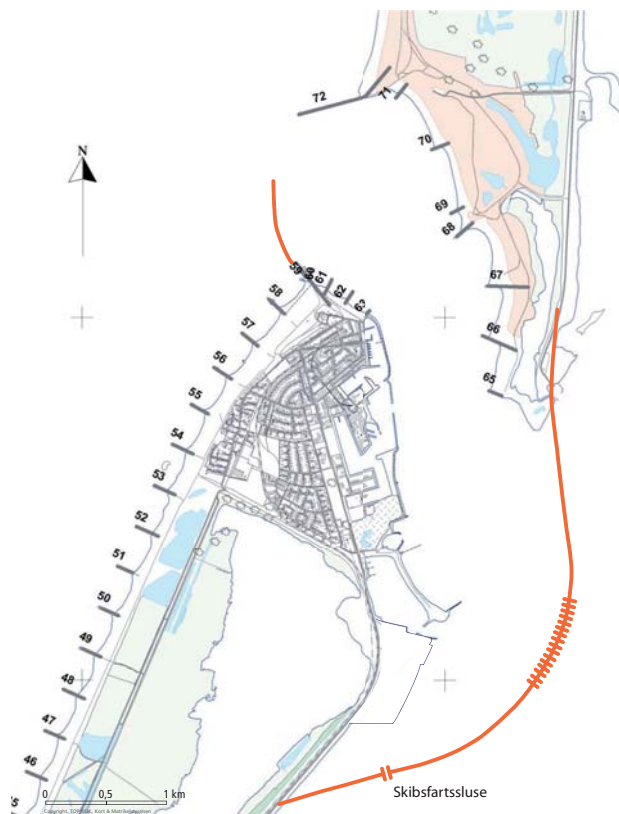
Figur 20. Principskitse af dæmning med skibsfartssluse inkl. forlængelse af hofde 58/59
