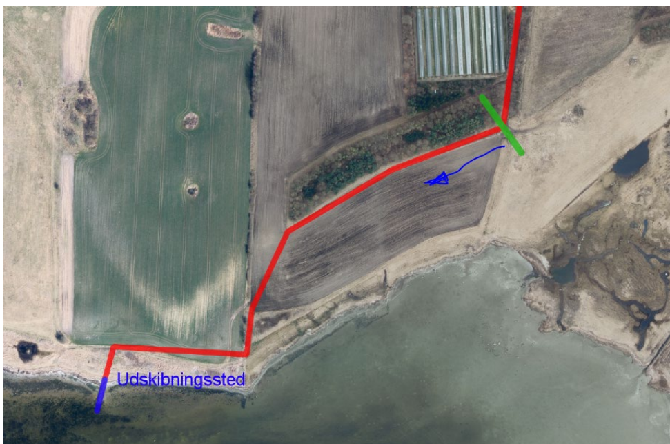
Kørepladerne udlægges fra grøn markering og til udslibningssted
