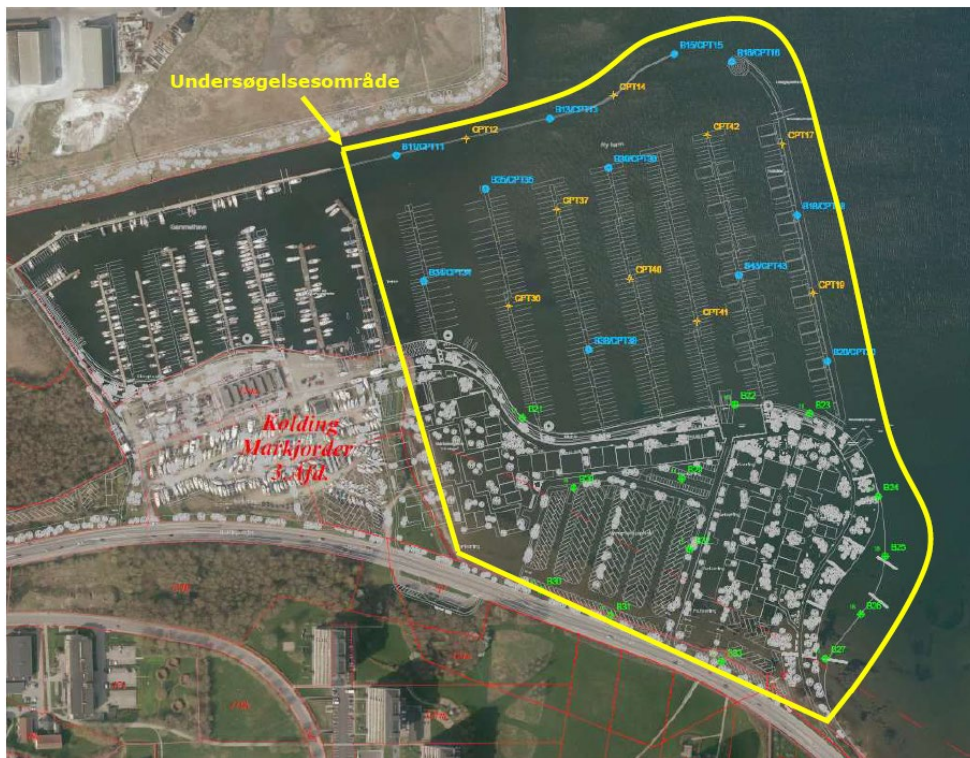
Figur 3: Udklip fra situationsplan med undersøgelsespunkter. Fremtidige forhold vist i lysegråt. Etape 1: Blå og gule punkter. Etape 2: Grønne undersøgelsespunkter
