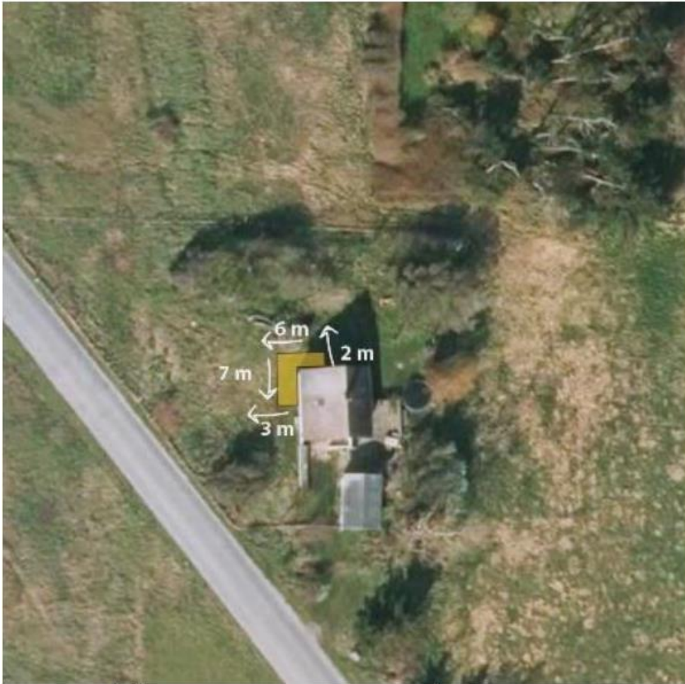
Figur 3: Billedet viser målene og udformningen af terrassen ved den nordvestlige del af ejendommen, samt den allerede etablerede terrasse på den sydvestlige del i tilknytning til bygningen.
