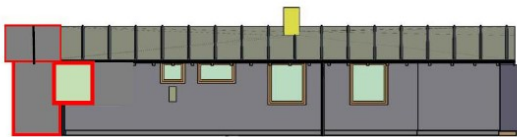
Facade mod vest – den ønskede tilbygning er markeret med rødt, vindue flyttet mod nord
