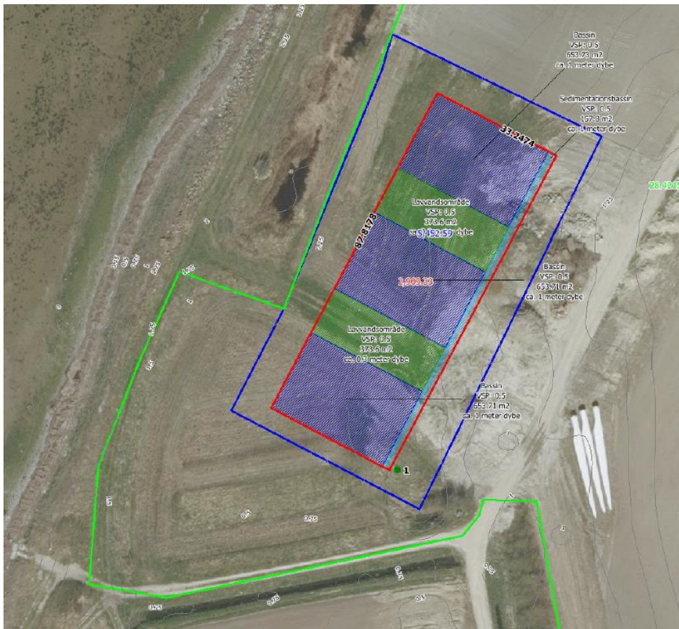
Fig. 2. Figur fra ansøgningsmaterialet, der viser placeringen og konstruktionen af det ansøgte minivådområde. Det røde omruds markerer minivådområdet. Det blå omruds markerer projektarealet.
