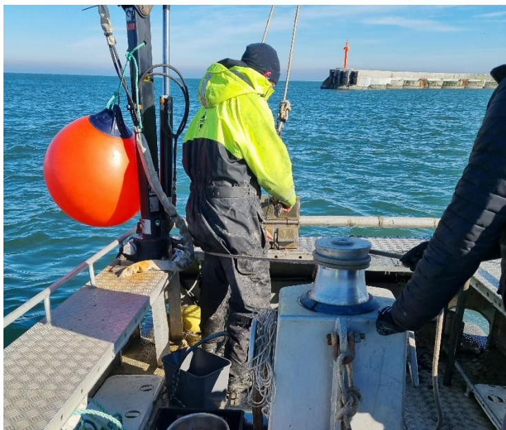
Figur 2 Håndtering af grab under prøvetagning.
