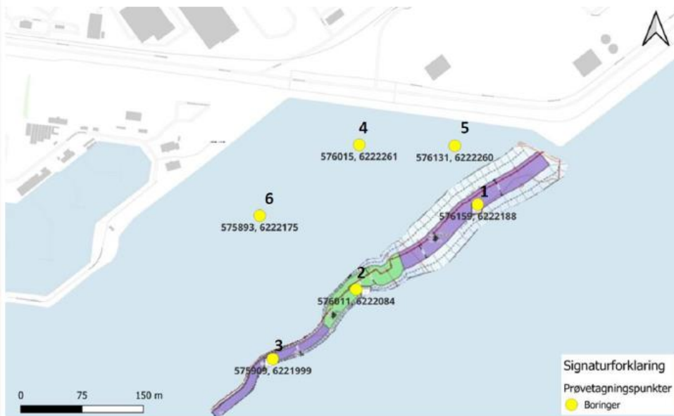
Figur 3 Placering af supplerende miljøtekniske boringer for ReWater landopfyldning. Koordinater i UTM-32.
