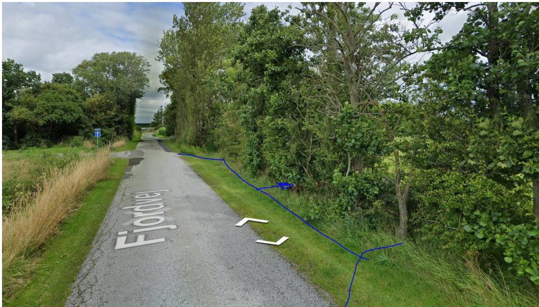
Vigeplads og anlæg af pumpestation etableres ved den blå markering. Under: Udstrækning af anlægget samt markering af areal for genplantning (blå).
