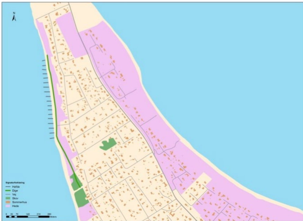
Figur A7 Projektscenarie 1: Dige med høfder foran
