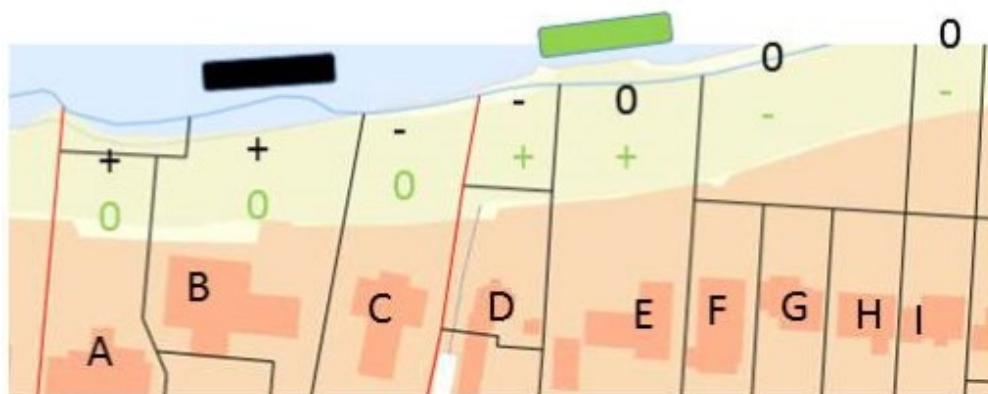
Figur 10 Bølgebryderes positive og negative effekt på kystlinjens tilbagevækst
