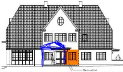
Det ny indgangsparti "frontspidsen" (rød viser udvidelsen af det fremskudte parti). Blå overtegning illustrerer eksisterende parti jf. foto under
