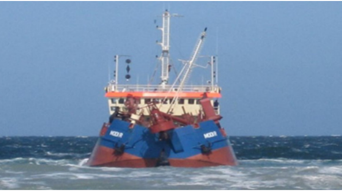
Sandsuger i færd med at splitte hvor sandet placeres på havbunden. På billedet ses, hvordan skroget splitter.Lodbjerg - Nymindegab.
