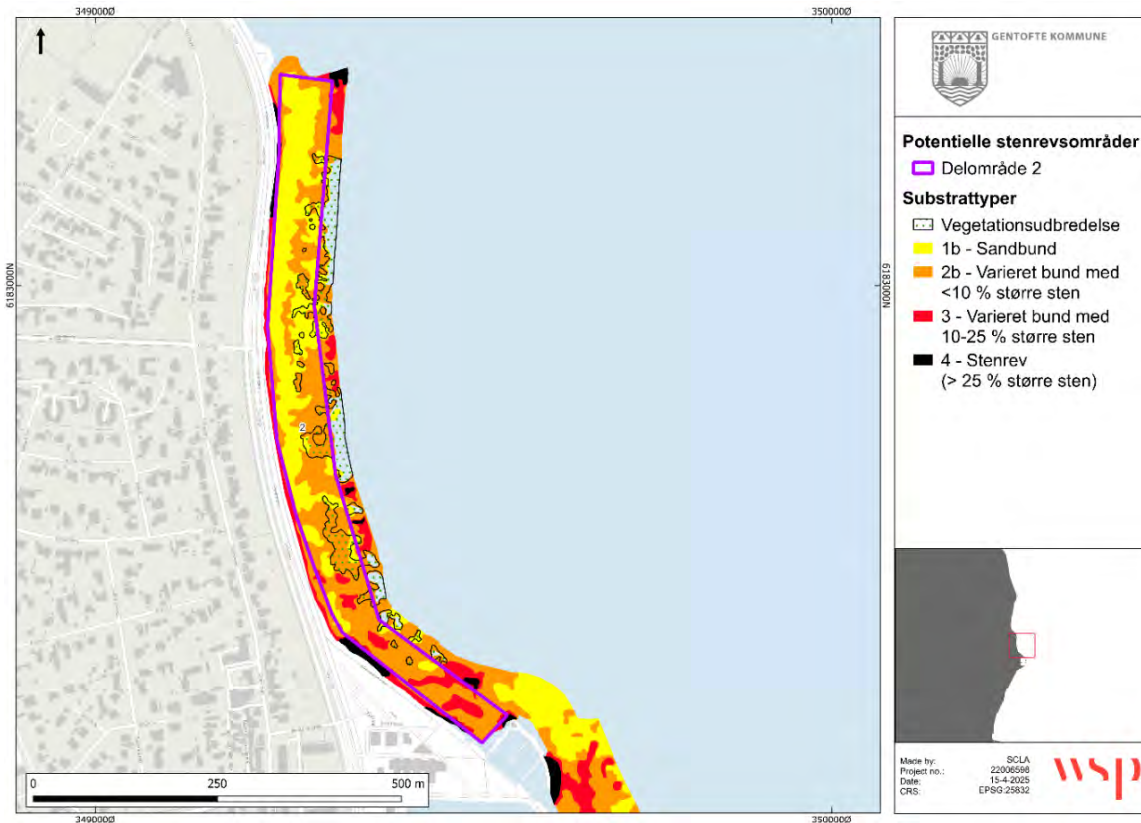
Figur 7: Substrattypekort udført på baggrund af Side Scan Sonar af WSP, der viser fordelingen af de tolkede substrattyper og afgrænsning af vegetationsudbredelse på havbunden syd for Knud Rasmussen-monumentet.
