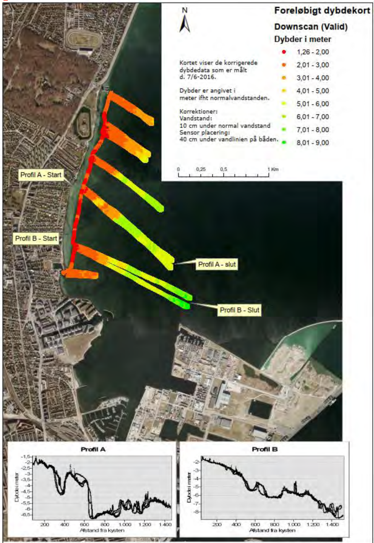
Figur 4-4. Dybdekort lavet ud fra pejling den 7. juni 2016 af havnefogeden i Gentofte Kommune. De to grafer viser dybdeprofilerne for transekterne/profilerne A og B.
