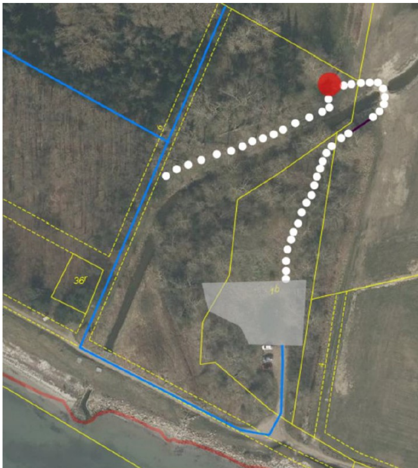
Figur 1 Luftfoto 2019 viser fugletårnsprojektet. Eksisterende sti markeret med blå linje. Ny grussti markeret med hvide prikker. Primitiv spang markeret med sort streg. Fugletårnets placering med rød cirkel. Grusbelægning af parkeringsplads grå markering.
