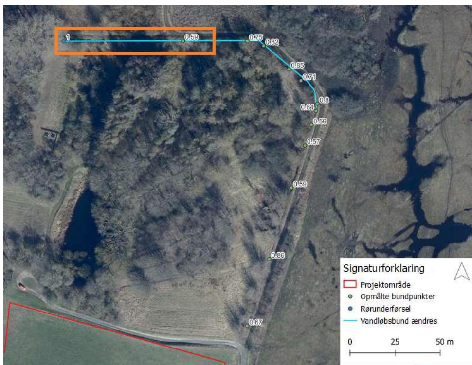
Fig. 4. Oversigt over målte bundpunkter i grøften langs Kirkebakken, indsendt af ansøger. Kystdirektoratet har, med orange, markeret den del af grøft reguleringen der ligger inden for strandbeskyttelseslinjen.
