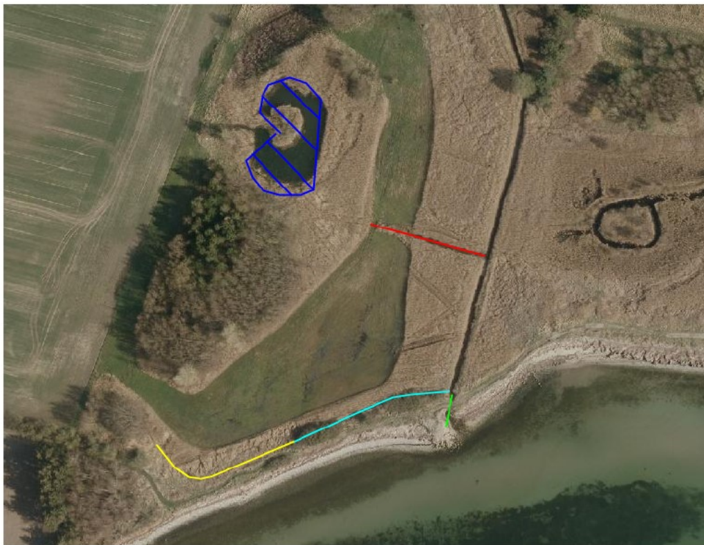
Figur 2: Oversigt over forhold, hvortil der meddeles dispensation. Turkisblå streg viser eksisterende grøft (grøft 1). Gul streg viser forlængelse af eksisterende grøft (grøft 2), som er en forlængning af en tidligere grøft. Rød streg viser grøft (grøft 3) på strandengen. Skraveret blå viser sø. Grøn streg viser rør fra grøft og ud til havet.
