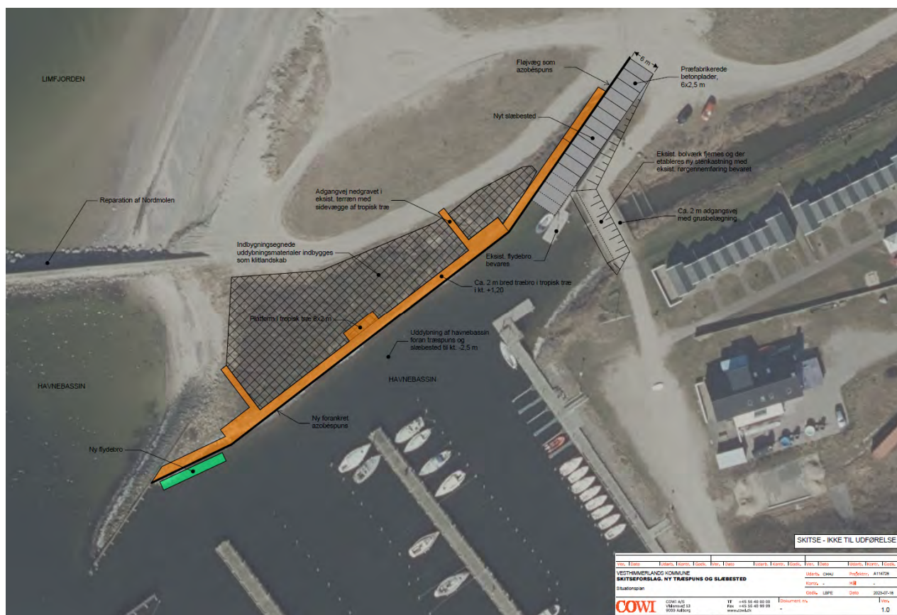
Figur 4-2 Skitse over situationsplan for ny azobéspuns (orange), flydebro (grøn) og nyt slæbested (grå).
