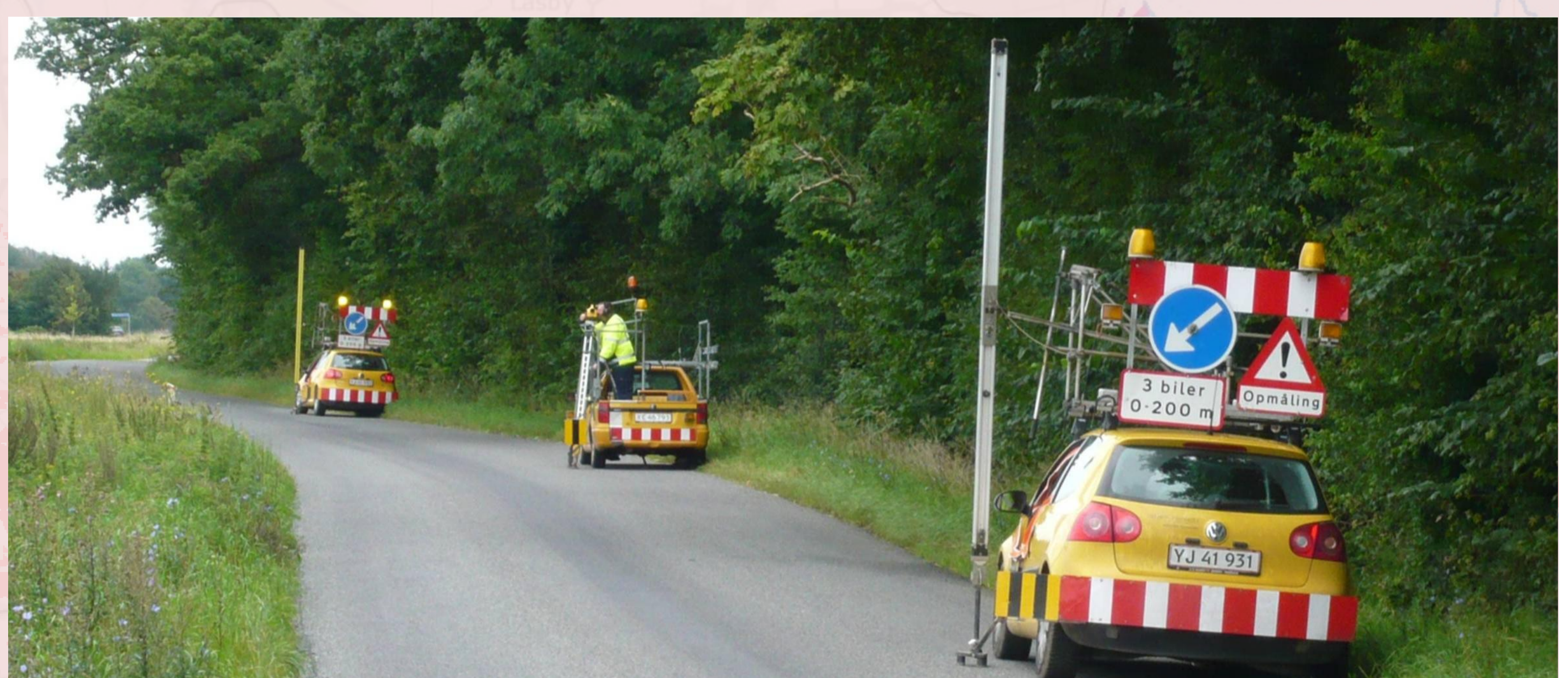
Figur 5 Motoriseret geometrisk nivellement under udførelse. Et smukt element i det danske landskab
