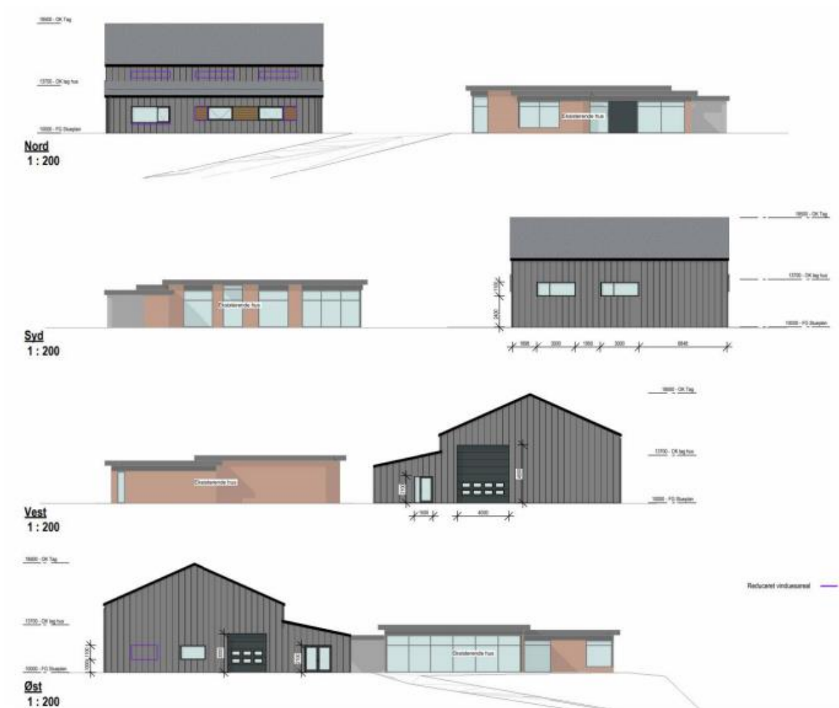
Fig. 6. Facadetegninger af det ansøgte maskinhus. De lilla markeringer indikerer en reduktion af det tidligere ansøgte vinduesareal.
