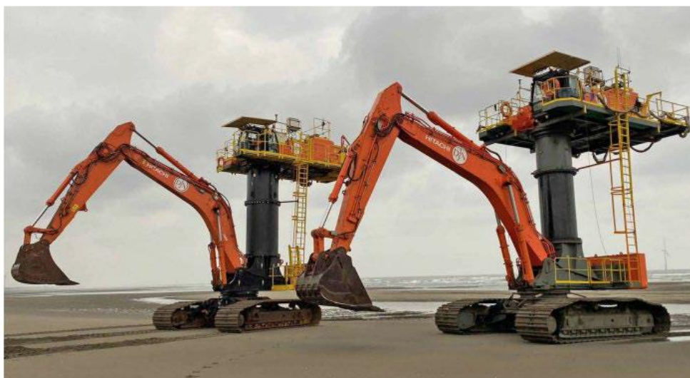
Fig. 4. Tilsendt fra ansøger. På figuren ses et billede af de to specialiserede gravemaskiner (Starfish), der skal samles på arbejdspladsen.
