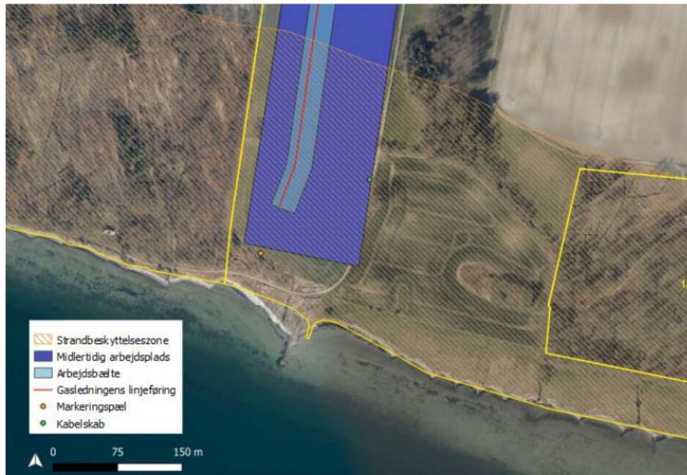
Bilag 1. Midlertidig arbejdsareal, arbejdsbælte, linjeføring, markeringspæl og kabelskab inden for strandbeskyttelseslinjen på matr.nr. 1a Stensby Mølle, Kalvehave i Vordingborg Kommune.
