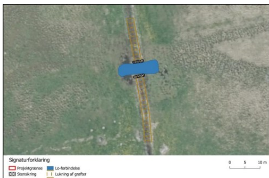
Figur 3-8 Principskitse til skabelse af lo-forbindelser ved grøfter.
