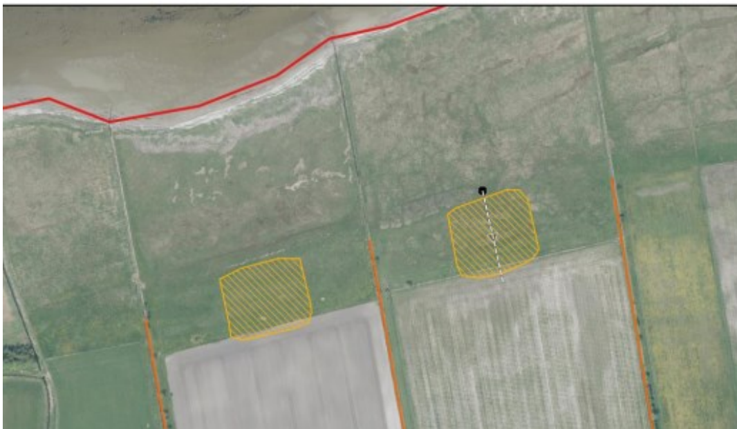
Figur 3-11 Gennembrydning af strandvold (orange skravering). Linjen gennem skraveringen er profilen for nedenstående tværsnit.
